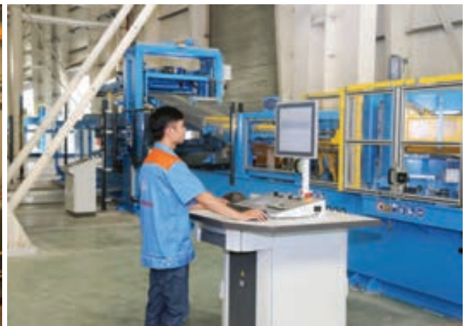
Dây chuyền cắt chéo lõi thép silic Cut to length line for silicon steel
