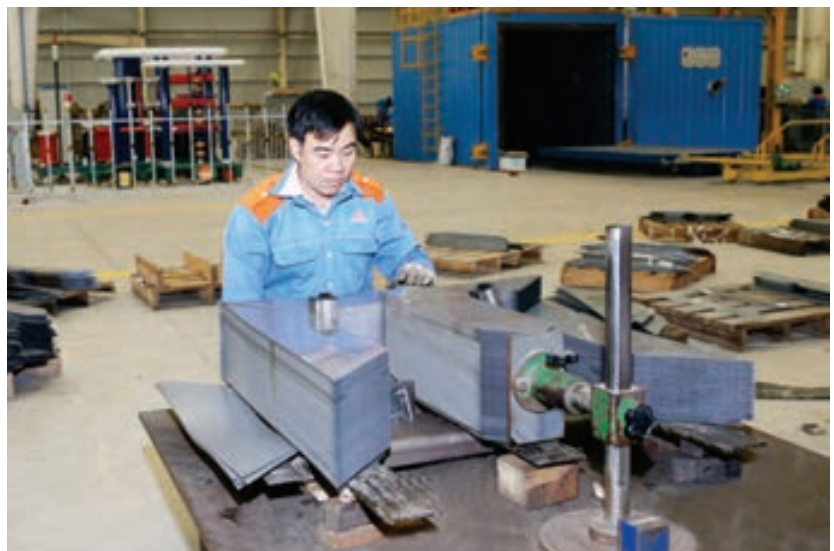
Lắp ghép lõi từ máy biến áp Transformer core assembling
