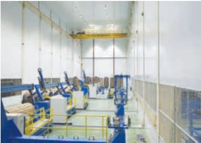
Xưởng chế tạo cuộn dây (nhiệt độ duy trì liên tục 25°C độ ẩm 55%) - Windings processing workshop. Maintaining temperature is 25oC, humidity is 55%
