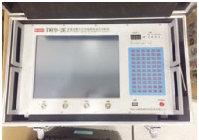
Thiết bị đo phóng điện cục bộ Multi - channel digital PD Integrativr analyzer
