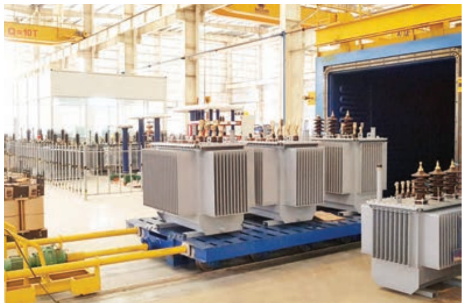
Hệ thống lò sấy và nạp dầu chân không - Drying oven and oil vacuum filling
