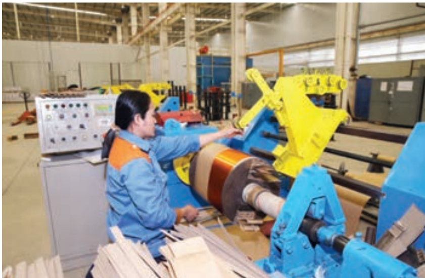
Máy quấn cuộn dây cao áp HV winding machine
